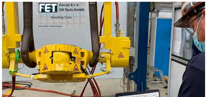
Hydraulischer Elevator mit Drehsystem und softwarebasierte Systemzusammenführung im Einsatz.
