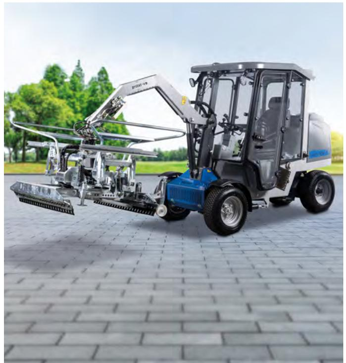
Die weltweit erste vollelektrisch angetriebene Pflasterverlegemaschine.
