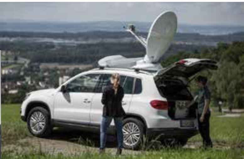
Das Ka2Go-Antennensystem wurde von ND SatCom speziell für Pkw entwickelt.
