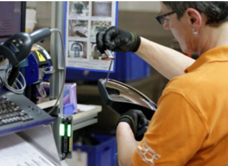
Qualität bei jedem Arbeitsschritt und bis ins kleinste Detail – Hier prüft eine Mitarbeiterin noch in der Produktion die Spaltmaß-Konformität.
